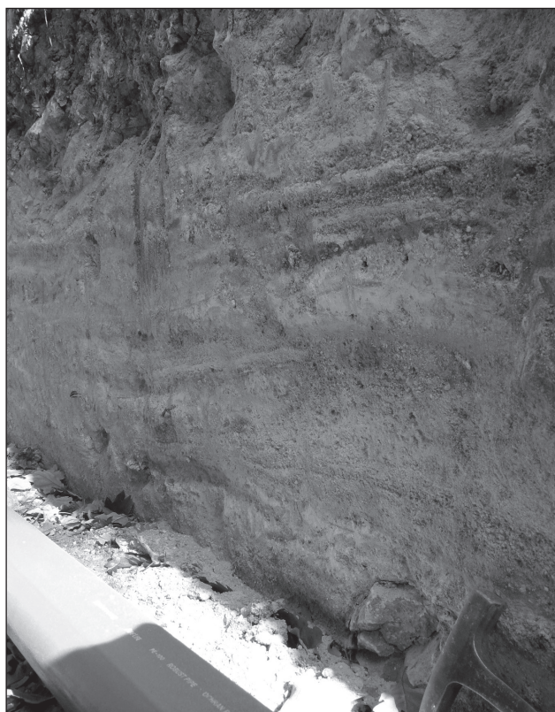
Obr. 7. Střídání hrubozrnnějších (šterčovitých) a jemnozrnnějších (písčitých) poloh v laminách až páscích. Foto P. Čáp.
