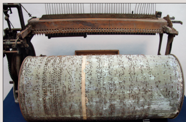
Obr. 15. Hlavní součásti orchestrionu (hrací válec, klaviatura a bubn), přelom 19./20. století, zapůjčil Ladislav Sluka.
