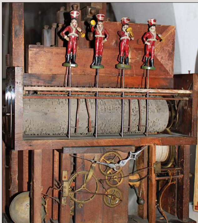
Obr. 5. Polodřevěné hodiny s píšťalovým hracím mechanismem a hracím válcem s několika skladbami, počátek 19. století, zapůjčil Miloš Klikar.
