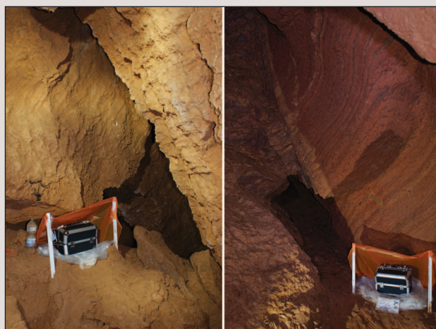
Obr. 8. Stanoviště přístroje Radim 3A během měření „koncentrace“ radonu v roce 2014 v Říceném dómu (Čerinka, vlevo) a Dračí tlamě (Arnoldka, vpravo). Na stanovištích bylo nutností zamezit skapové vodě vtékat do ochranné schrány přístroje. Foto Karel Křtěn.
