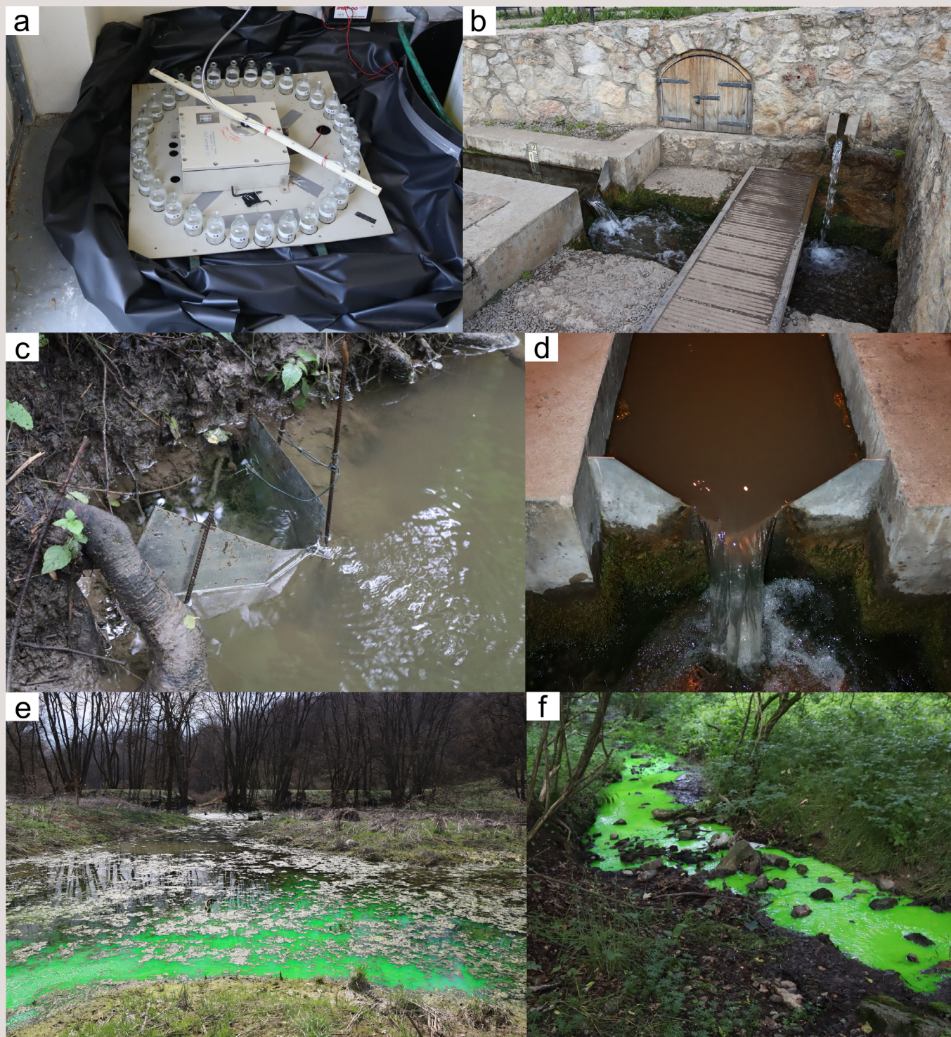
Obr. 4. Vzorkovaná místa a ztrátový úsek Bubovického potoka. a – Automatický vzorkovač ve vodárně v Srbsku; b – pramen Svatý Jan pod Skalou, vlevo větev Ivan, vpravo větev Ivanka; c – zachycená část pramene V nivě a její přetok do Loděnice; d – zakalený pramen Svatý Jan pod Skalou 3 hodiny před kulminací 2. května 2021 v 21:30; e – fluorescein z první injekce rozptýlující se v jezeře mokřadu; f – fluorescein z páté injekce v úseku s největší intenzitou ztrát.
