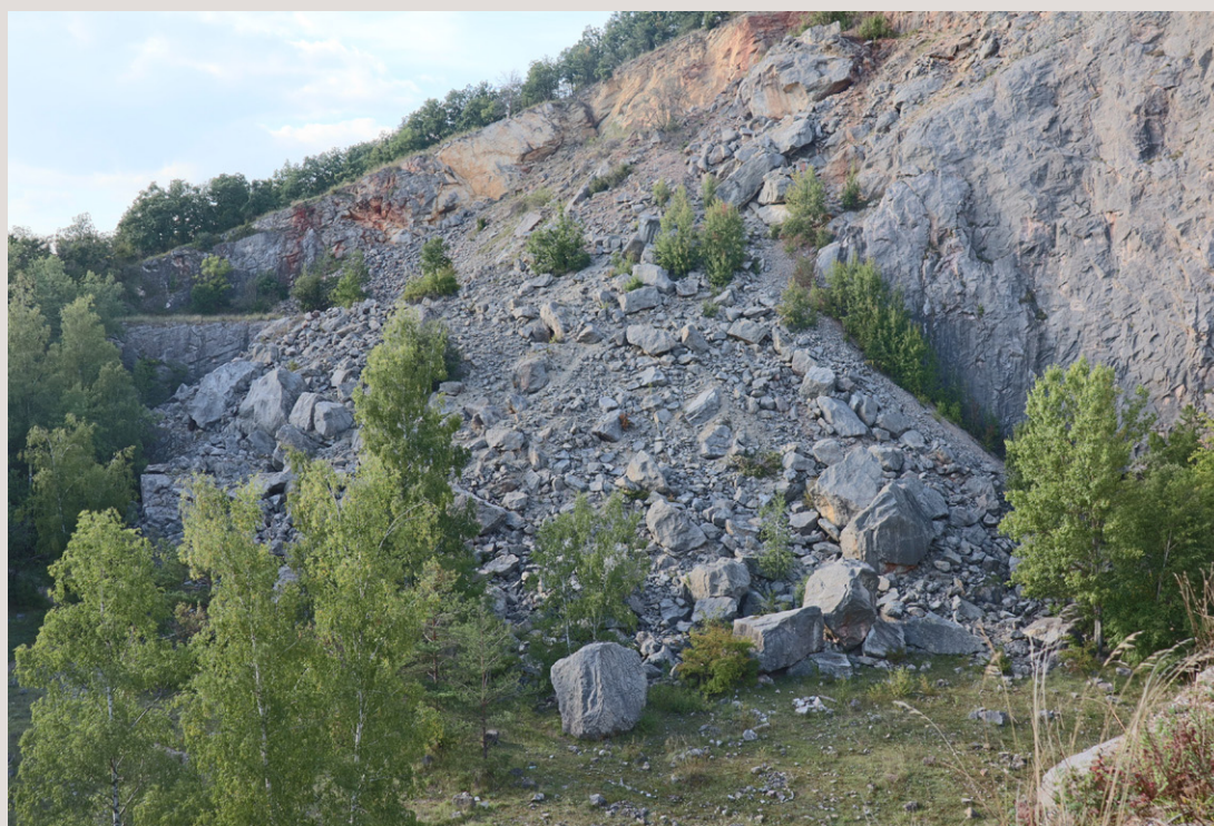
Obr. 4. Rozval horniny po provedeném komorovém odstřelu ve vápencovém lomu Na Chlumu u Srbska s velkými rozdíly ve fragmentaci horniny. Foto M. Hejna.
