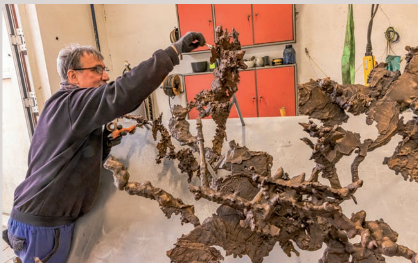
Obr. 9A, B. Bronzový model vznikl na základě nového náročného měření a 3D skenování vnitřních jeskynních prostor. Následovalo složité a časově náročné počítačové zpracování dat a vytištění modelu na 3D tiskárně. Model byl potom odlit z bronzu. Foto M. Frouz.
